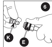
**AVERTISSEMENT :** la projection d'objets pourrait provoquer de graves blessures. S'assurer que la buse est complètement insérée sur la douille du dispositif de branchement rapide et que le joint de blocage est complètement engagé (vers l'avant) avant d'appuyer sur la détente du pistolet de pulvérisation.
