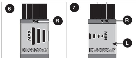
Réglez la pression en faisant tourner le régulateur Dial-N-Wash (L) dans le sens des aiguilles d'une montre pour augmenter la pression ou dans le sens contraire pour diminuer la pression, en alignant la flèche avec la ligne indiquant la pression désirée du régulateur Dial-N-Wash.
