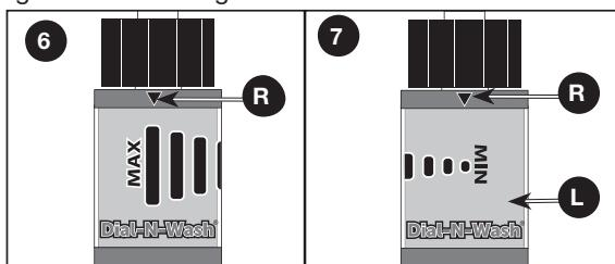
Ajuste la presión girando Dial-N-Wash (L) en sentido horario para subir la presión o en sentido antihorario para bajar la presión, alineando la flecha con la barra de presión deseada en Dial-N-Wash.
