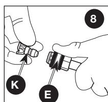
**⚠️ AVERTISSEMENT :** la projection d'objets pourrait provoquer de graves blessures. S'assurer que la buse est complètement insérée sur la douille du dispositif de branchement rapide et que le joint de blocage est complètement engagé (vers l'avant) avant d'appuyer sur la détente du pistolet de pulvérisation.
