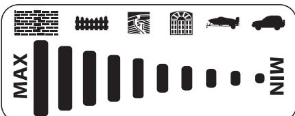
**NOTA:** Para aplicar productos químicos instale la boquilla negra de baja presión y gire el Dial-N-Wash a la posición de MAX.
