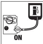
**9****Verifique que el interruptor del motor esté en la posición ON**
